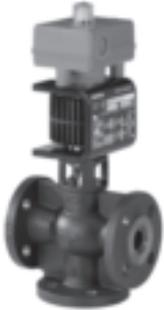
带电磁执行器的混合三通或两通阀, 适用于闭环系统中的冷冻水或低温热水的模拟量控制。带定位控制, 阀位反馈信号, 弹簧复位和手动功能。
