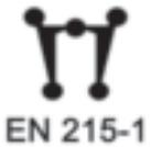
两管制采暖系统中房间温度控制散热阀。流量可调
