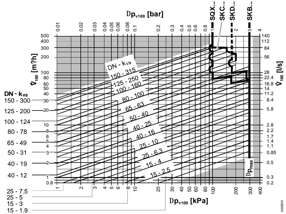
$\Delta p_{max}$  = 阀门两端的最大允许压差，在此压差范围内相配执行器能在整个行程准确地驱动阀门
