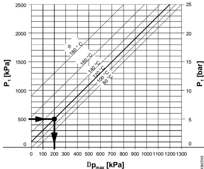
$\Delta p_{\max}$  = 阀门处于几乎关闭状态时，阀门两端的最大允许差压，很大程度上可以避免气蚀
