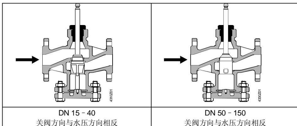
带导向的阀塞直接与阀杆连接。
